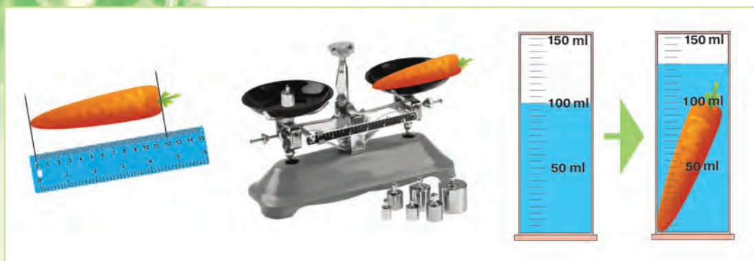
12. ábra. Szabálytalan alakú test méreteinek, tömegének és térfogatának meghatározása
